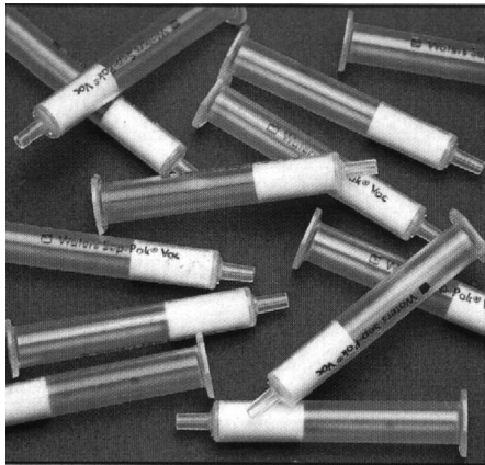
8. ábra Szilárd fázisú extrakcióhoz használatos, gyári készítésű, általában 100–500 mg szilárd szorbenst tartalmazó egyszerű használatos oszlopok, valamint a több oszlop befogatására és az oldószer átszivtatására szolgáló, csapokkal ellátott vákuumkamra képe.
