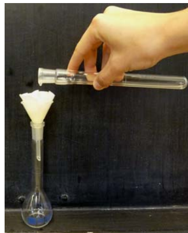
8.ábra. Az oldat átszűrése 50ml-es mérőlombikba lombikba.
