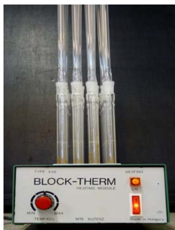
3.ábra. Block-therm készülék a roncsoláshoz előkészített roncsolócsövekkel.
