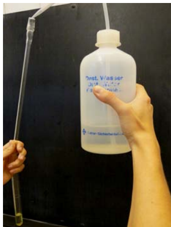
7.ábra. A hűtőben lecsapódott folyadék kémcsőbe való visszamosása desztillált vízzel.
