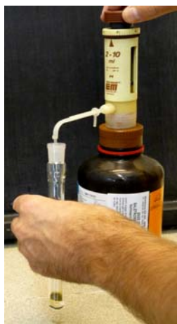
4. ábra. 3 ml 65% (m/m) salétromsav adagolása a roncsolócsőbe
