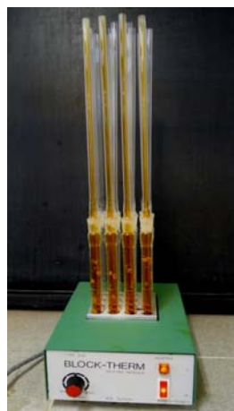
5. ábra. A roncsolás kezdetén intenzív gázképződést tapasztalunk. A fejlődő nitrozus gázok veszélyesek, fontos a megfelelő elszívás.
