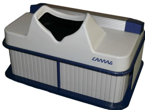
11. ábra UV-kabinet. Megfelelő adapterrel ellátva az ablakon keresztül le is lehet fényképezni a réteget, vagy a redőny részleges félrehúzása után puha ceruzával körülrajzolhatjuk a foltokat.
