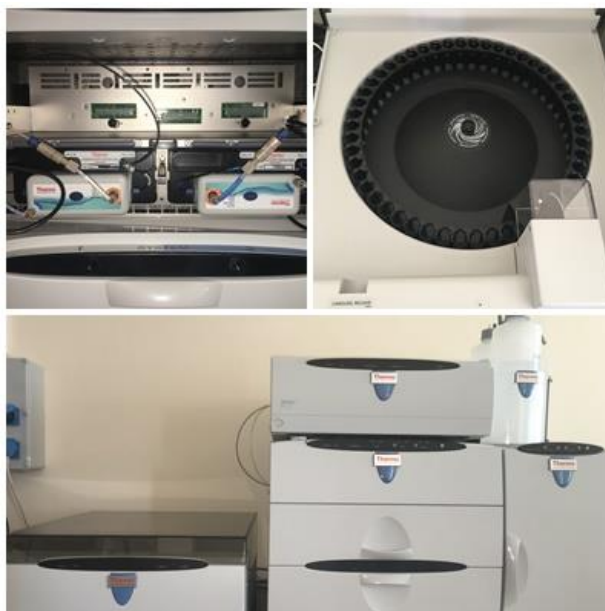
6. ábra: Dionex ICS-5000+ típusú ionkromatográf
