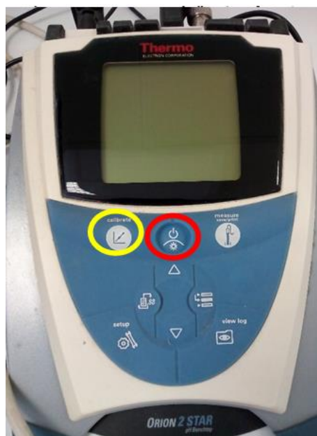
4. ábra : Orion 2 Star pH-mérő ( bekapcsoló gomb , Calibrate )
