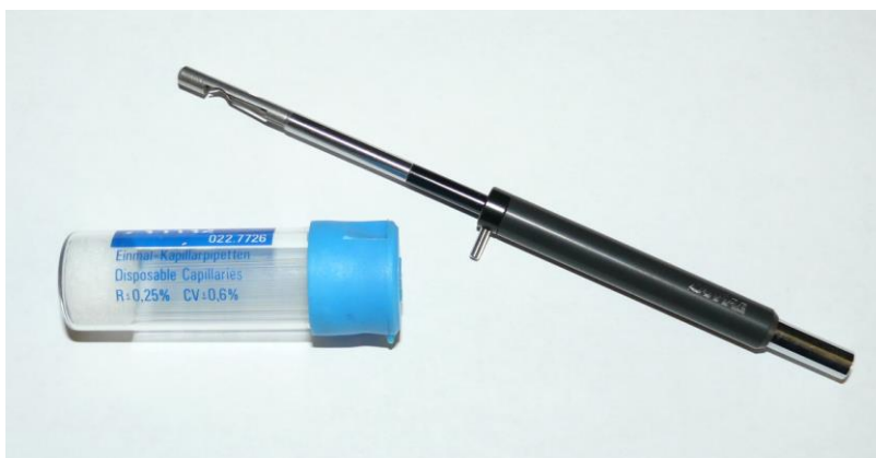
10. ábra Egy doboznyi 1 mikroliteres bemérő kapilláris, valamint a hozzájuk tartozó adapter. A bemérő kapillárisok meglehetősen költségesek, ami korlátozza a használatukat.
