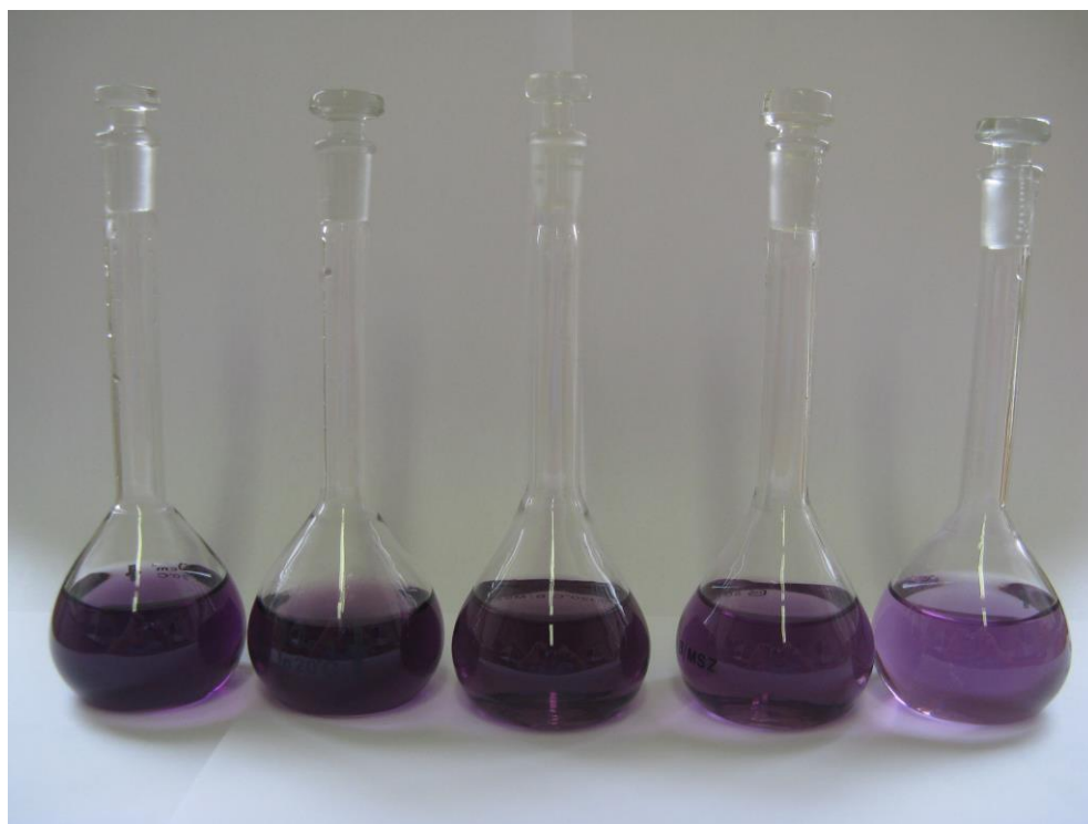
15. ábra. A \text{Fe}(\text{Sal})^+ -komplexből készített különböző koncentrációjú oldatok. ( \text{pH} = 2,0 , c(\text{FeCl}_3) = 9,98 \times 10^{-4} \text{ g/cm}^3 a szalicilsav koncentrációja pedig jobbról balra haladva a következők voltak: 2,06 \times 10^{-5} \text{ g/cm}^3 ; 4,13 \times 10^{-5} \text{ g/cm}^3 ; 6,19 \times 10^{-5} \text{ g/cm}^3 ; 8,25 \times 10^{-5} \text{ g/cm}^3 és 1,03 \times 10^{-4} \text{ g/cm}^3 ).
