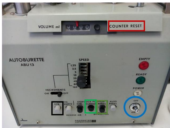
5. ábra : ABU buretta (bekapcsoló billenő kapcsoló, Closed, Refill, Titr., Counter Reset)
