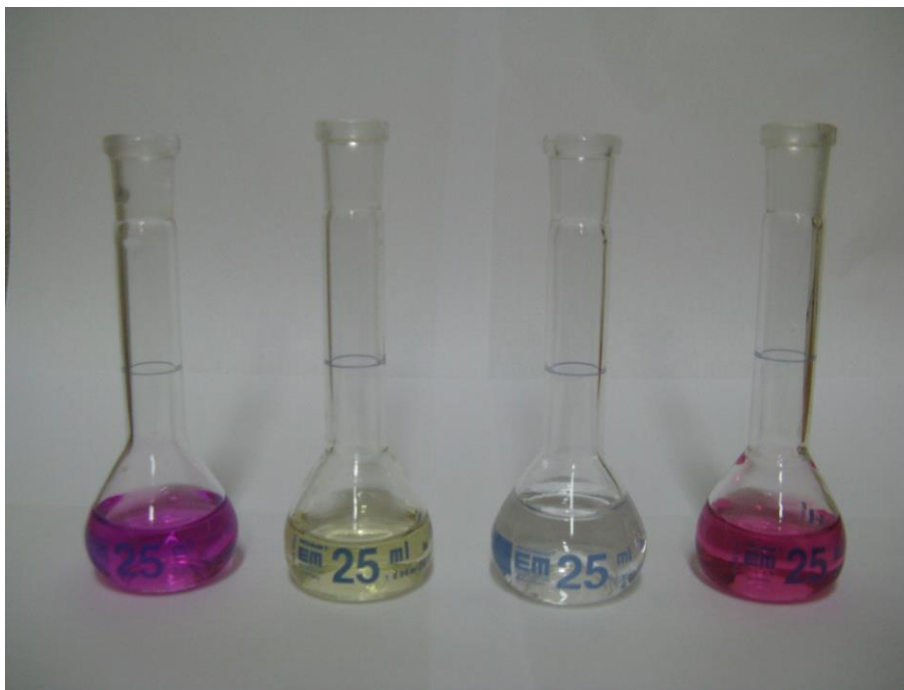
8. ábra A gyakorlaton elkészítendő egyik oldatsorozat (balról jobbra haladva: 2,5 \times 10^{-4} mol/dm 3 KMnO 4 oldat (0,1 M H 2 SO 4 -ra nézve), 2 \times 10^{-4} mol/dm 3 K 2 Cr 2 O 7 oldat (0,1 M H 2 SO 4 -ra nézve), 0,1 M H 2 SO 4 oldat (vak) és egy ismeretlen amely mindkét komponenst tartalmazza (0,1 M H 2 SO 4 -ra nézve)).
