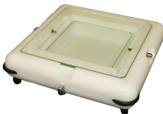
6. ábra Horizontális futtatókád.
