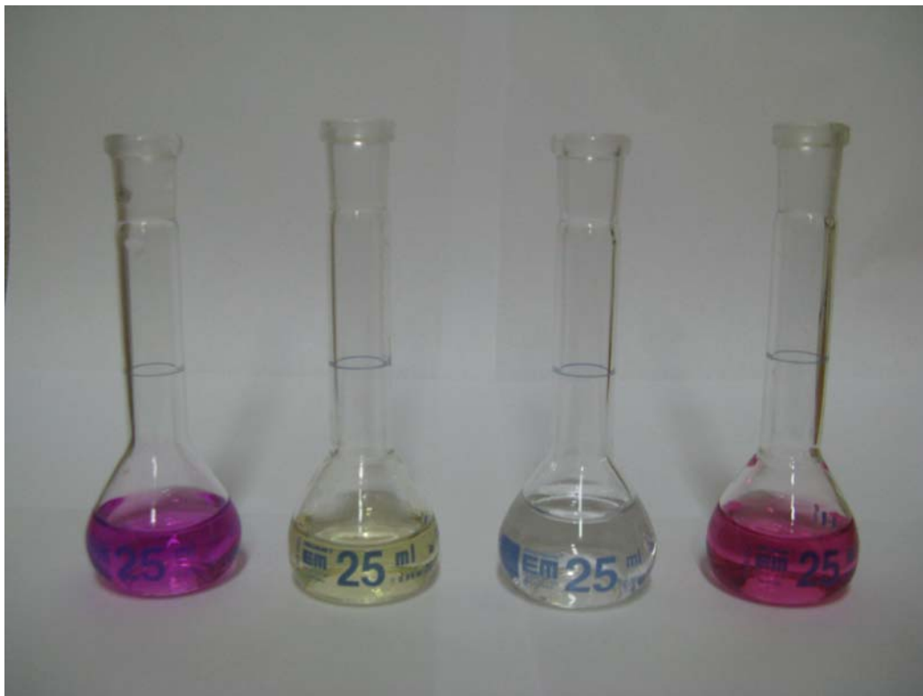
8. ábra A gyakorlaton elkészítendő egyik oldatsorozat (balról jobbra haladva: 2,5 \times 10^{-4} mol/dm 3 KMnO 4 oldat (0,1 M H 2 SO 4 -ra nézve), 2 \times 10^{-4} mol/dm 3 K 2 Cr 2 O 7 oldat (0,1 M H 2 SO 4 -ra nézve), 0,1 M H 2 SO 4 oldat (vak) és egy ismeretlen amely mindkét komponenst tartalmazza (0,1 M H 2 SO 4 -ra nézve)).
