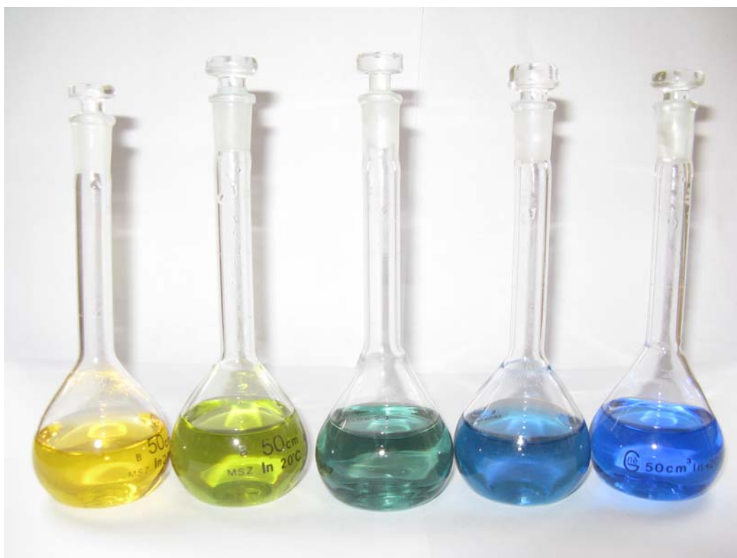
12. ábra. A brómkrezolöld indikátor különböző pH-jú oldatai
