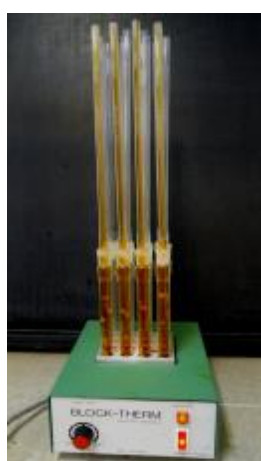
A roncsolás kezdete-n intenzív gázképződést tapasztalunk. A fejlődő nitrózus gázok veszélyesek, fontos a megfelelő elszívás.
