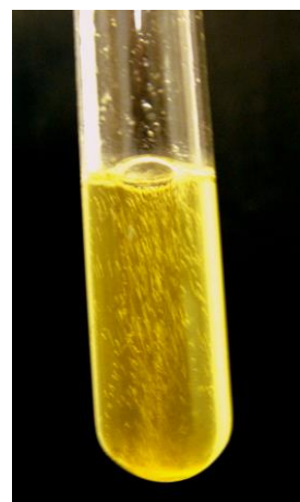
A hidrogén-peroxid hozzáadásakor erőteljes pezsgés lép fel.
