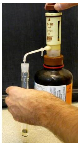
3 ml 65% (m/m) salétromsav adagolása a roncsolócsőbe
