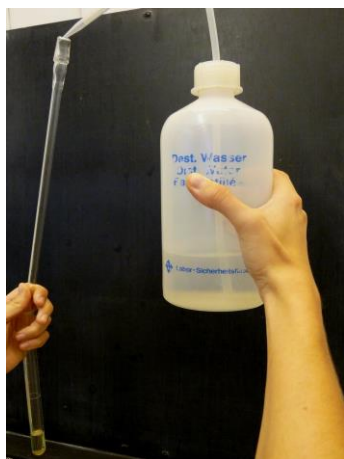
A hűtőben lecsapódott folyadék kémcsőbe való visszamosása desztillált vízzel.
