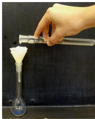
Az oldat átszűrése 50ml-es mérőlombikba.
