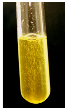
A hidrogén-peroxid hozzáadásakor erőteljes pezsgés lép fel.
