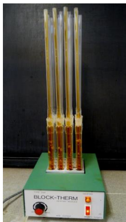
A roncsolás kezdetén intenzív gázképződést tapasztalunk. A fejlődő nitrózus gázok veszélyesek, fontos a megfelelő elszívás.
