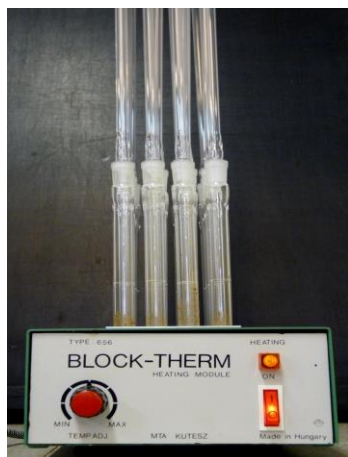
Block-therm készülék a roncsoláshoz előkészített roncsolócsövekkel.
