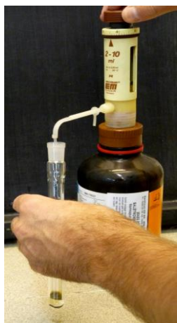
3 ml 65% (m/m) salétromsav adagolása a roncsolócsőbe
