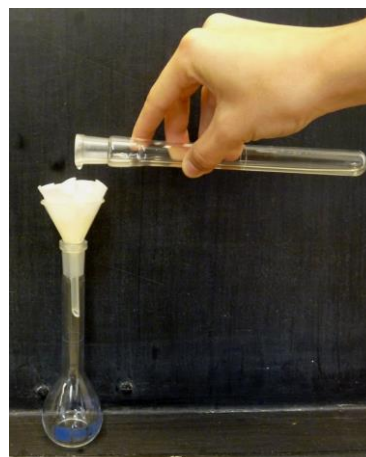
Az oldat átszűrése 50ml-es mérőlombikba.
