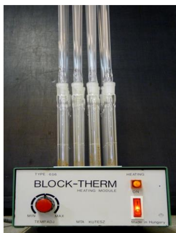
Block-therm készülék a roncsoláshoz előkészített roncsolócsövekkel.
