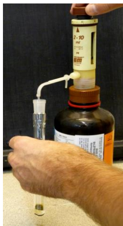
3 ml 65% (m/m) salétromsav adagolása a roncsolócsőbe
