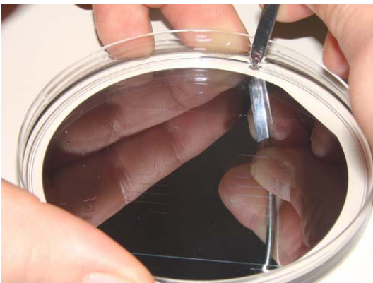
5, Az öntőformára ráöntjük a PDMS és a térhálósító adalék 1:10 arányú keverékét, ami 60°C-on félóra alatt megkeményedik.
