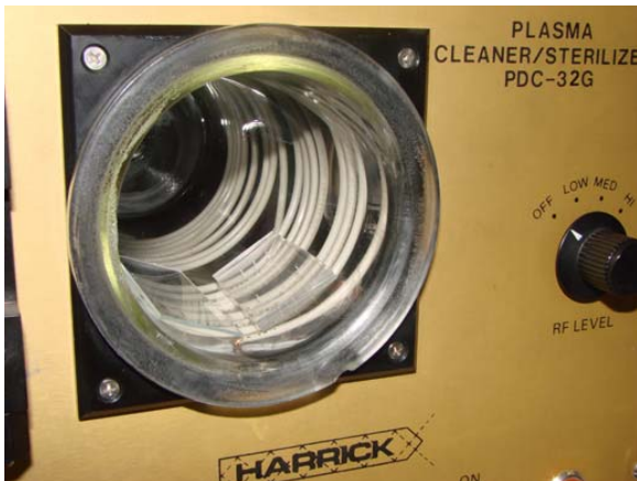
9, A műanyag és az üveg fedőlemez megfelelő felületeinek ativálása azok „összeragasztásához” (sealing) levegő plazma segítségével.
